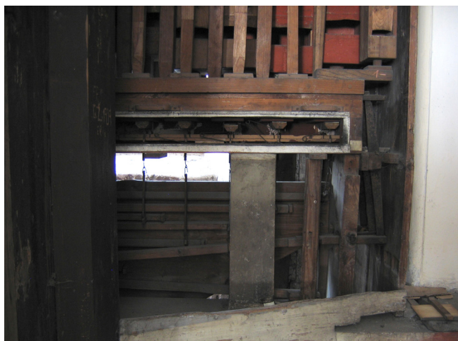
Obr. 5. Ventilová komora pedálové vzdušnice s trakturami. Foto: Eva Francová.
