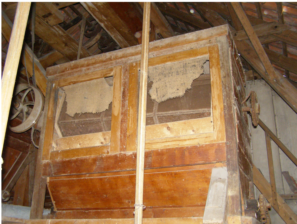
Obr. 9. Chodovlice č.p. 45, 3NP, hranolový vysévač a závěsy rovinného vysévače. Foto: Jan Koloc, 10. 4. 2009.
