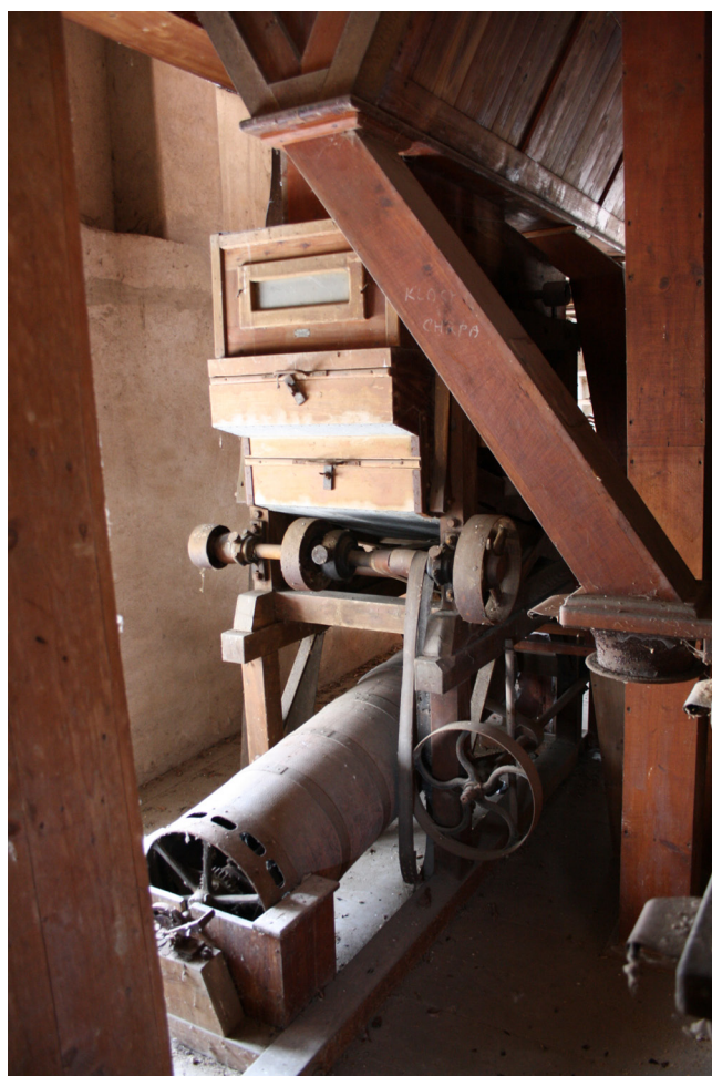
Obr. 8. Chodovlice č.p. 45, 3 NP, kombinované čistící ústrojí od f. Šlajner. Foto: Jan Frundl, 11. 3. 2010.
