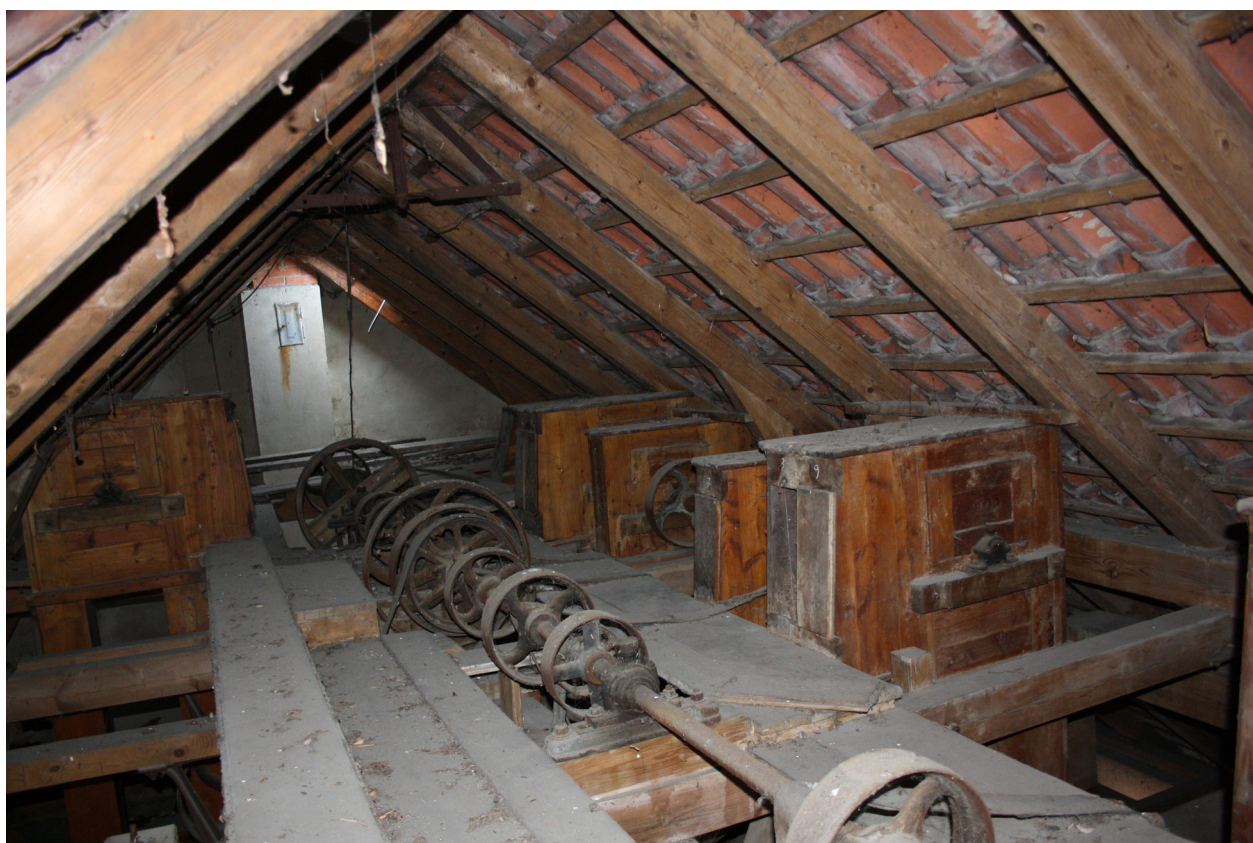
Obr. 10. Chodovlice č.p. 45, podstřeší, transmisa a skříňě korečkových výtahů. Foto: Jan Frundl, 11. 3. 2010.
