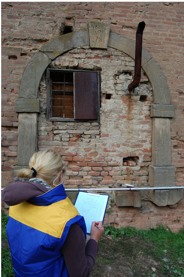
Obr. 5. Ortogonální zaměrování prováděné přímo v terénu umožňuje poměrně rychle získat přesný kresebný plán dokumentované situace. Foto: Ivan Peřina 2010.
