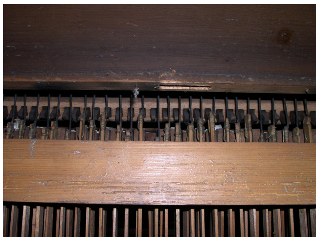
Obr. 9. Rtyně nad Bílinou, kostel sv. Martina, mechanismus manuálové spojky v hracím stole (nezařazený). Foto J. Belis.
