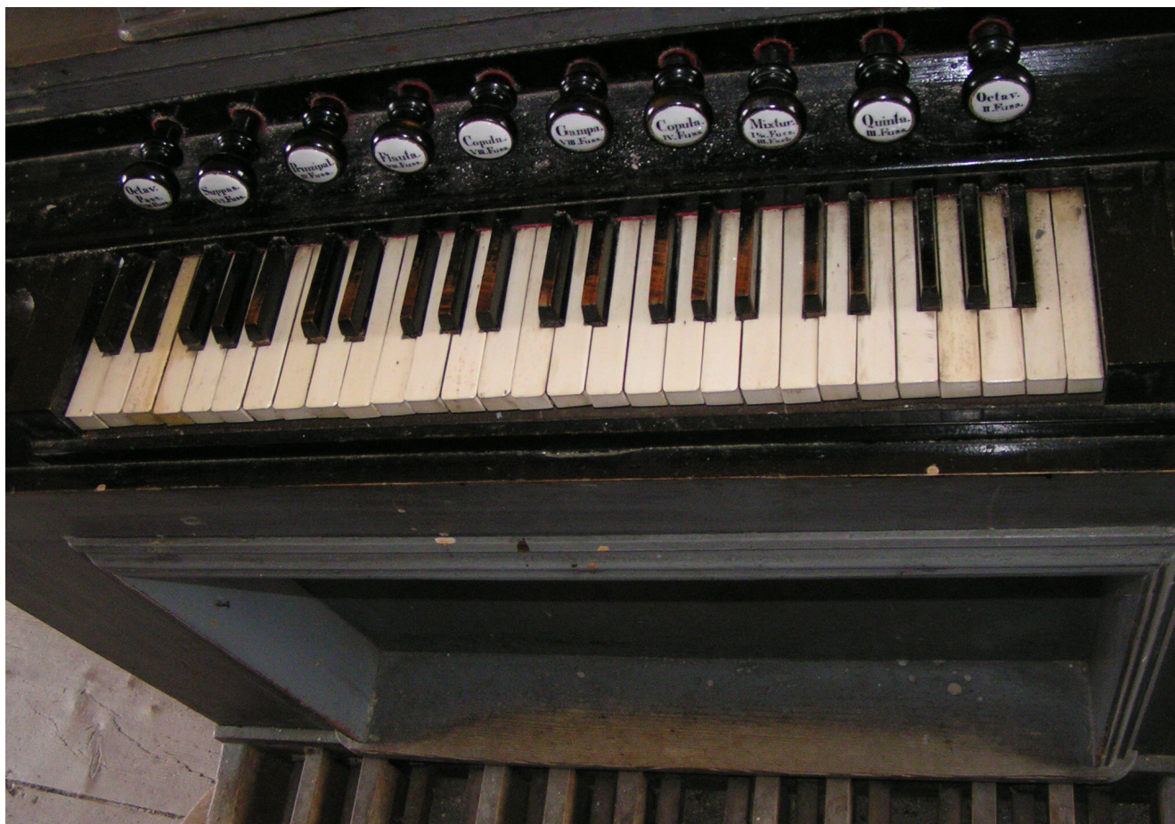
Obr. 12. Hradiště, kostel sv. Vavřince hrací stůl varhan Štefana Müllera s netradičním situováním rejstříkových manubií nad manuálovou klaviaturu. Foto V. Honys.
