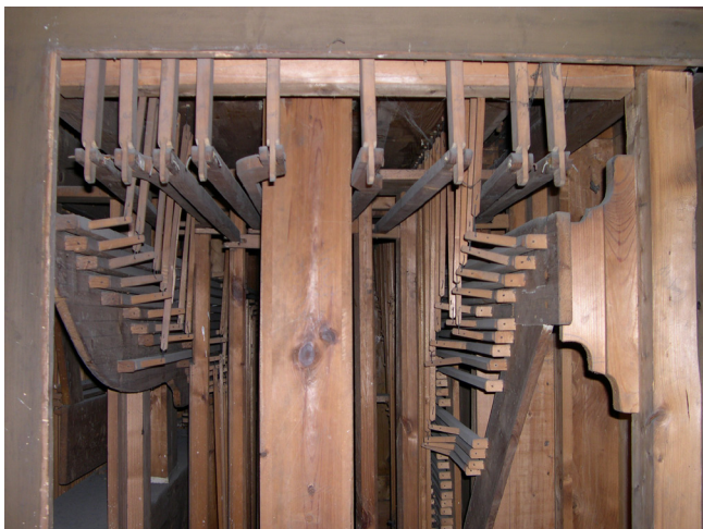
Obr. 7. Rtyně nad Bílinou, kostel sv., Martina, hrací a rejstříková traktura vzdušnice v postamentu nástroje. Foto J. Belis.
