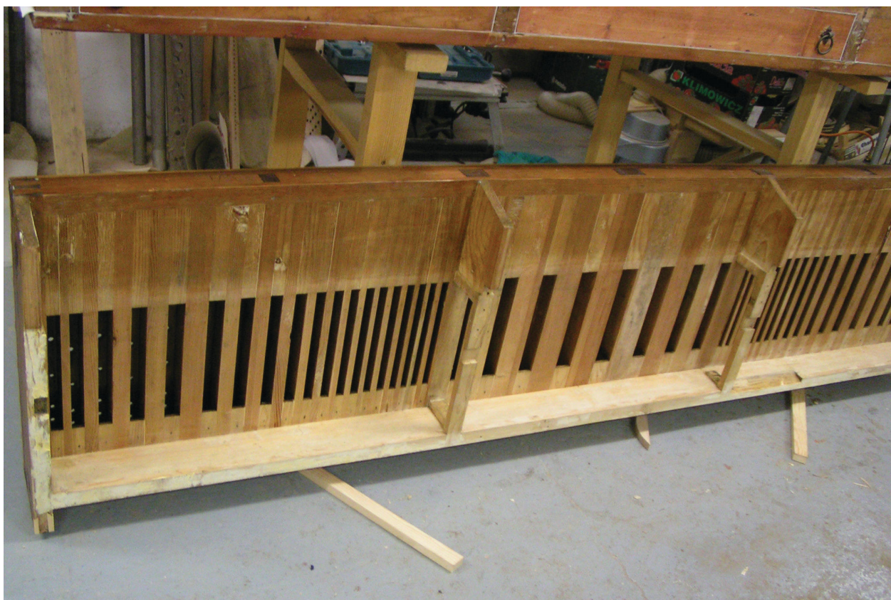
Obr. 8. Chabařovice, detail demontované vzdušnice hlavního stroje. Foto: Vít Honys.
