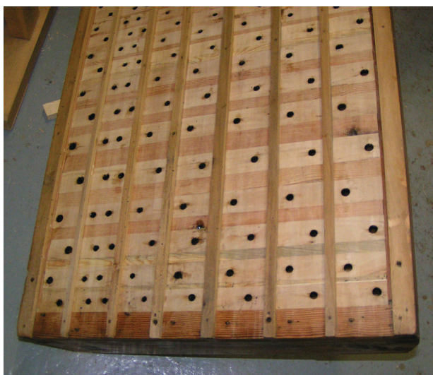
Obr. 9. Chabařovice, detail vrchní části vzdušnice hlavního stroje v průběhu restaurování. Foto: Vít Honys.
