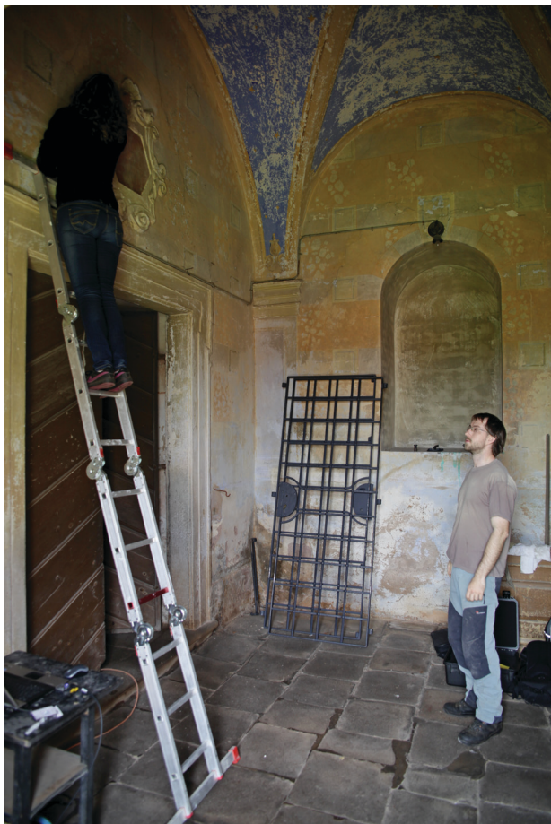
Obr. 4. Ukázka ručního laserového skenování v praxi při dokumentaci datační kartuše v kostele Všech Svatých v Heřmánkovicích. Foto: David Skalický, 2014.
