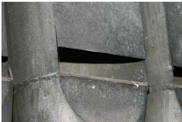
Obr. 3. Klášterec nad Ohří, kostel Nejsvětější Trojice, detail natrženého okraje horního labia prospektové píšťaly hlavního stroje. Foto: Jiří Belis 2006.
