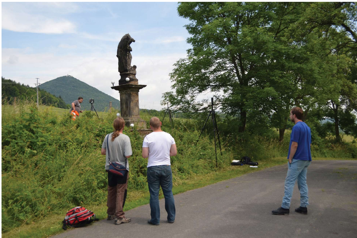
Obr. 2. Digitalizace sochy sv. Prokopa pomocí stacionárního laserového skeneru. Foto: Antonín Kadlec, 2012.
