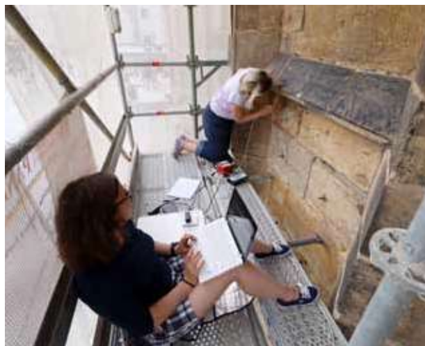
2) Aplikace odraživostní spektrometrie na kamenném zdivu jižní věže katedrály sv. Víta. Autor: K. Kovářová.
