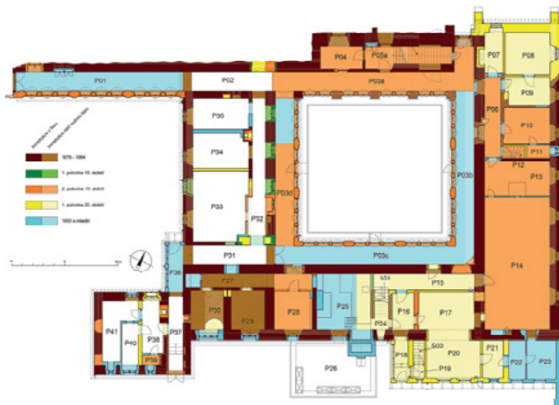
Obr 3. Půdorys přízemí s vyhodnocením stavebního vývoje. Zaměření: Ing. Radek Růžička, 2013; úprava a vyhodnocení: Jaroslav Skopec, 2018 s úpravou 2024
